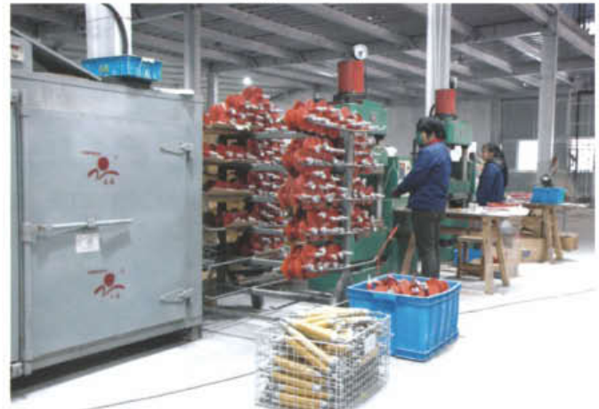
模压硫化 Molding & sulfuration
